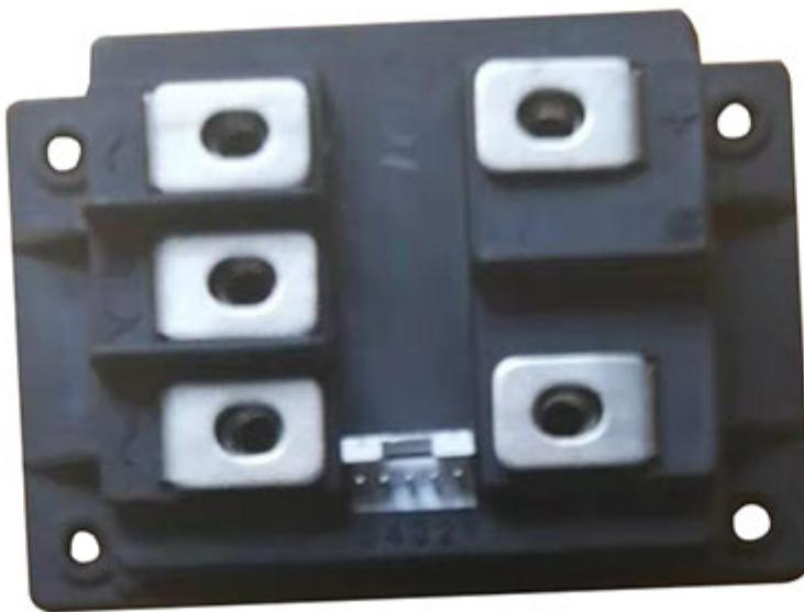
压接式和焊接式可控硅模块有哪些区别？可控硅模块属于一种使用模块封装形式，拥有三个PN结的四层结构的大功率半导体器件，这种可控硅模块的体积非常的小，结构也十分的紧凑，对于维修与安装都有很大的作用，可控硅模块的类型非常的多，比方说压接式可控硅模块、焊接式可控硅模块等，很多人不是很清楚两者之间的差异，下面详细的进行区分一下。①从电流方面来讲，焊接式可控硅模块可以做到160A电流，同时压接式模块的电流就能够达到1200A这就是讲低于160A的模块，不只是有焊接式的，同时也有压接式的。②从外形方面来讲，焊接式的可控硅模块远远没有压接式的外形比较好，压接式的属于一体成型，技术十分的标准，焊接式的局部
